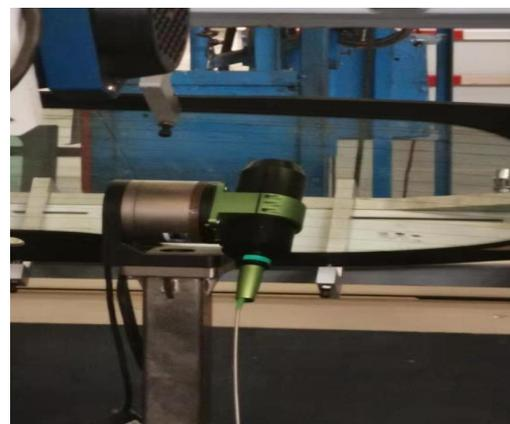
前后挡玻璃，天窗玻璃，车载玻璃等厚度曲率扫描测量
